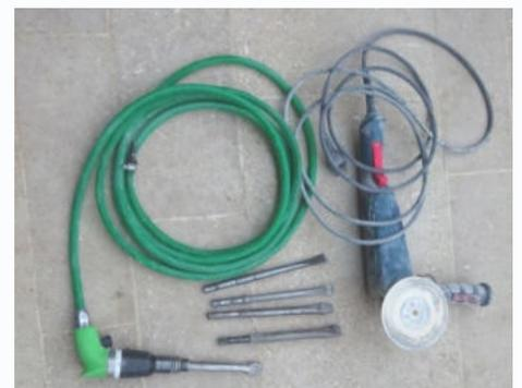
Pistolet pneumatique et disqueuse
